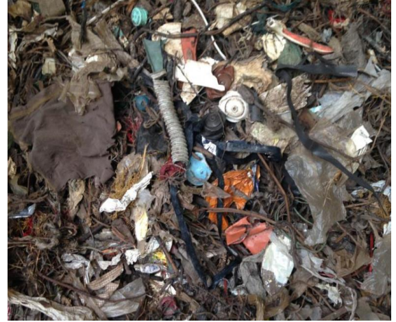
Bild 6-8: Schwergut (links) und Kunststofffraktion (rechts) aus der Kompostaufbereitung mittels Sichter und NIR [RTT-Steinert 2016]
