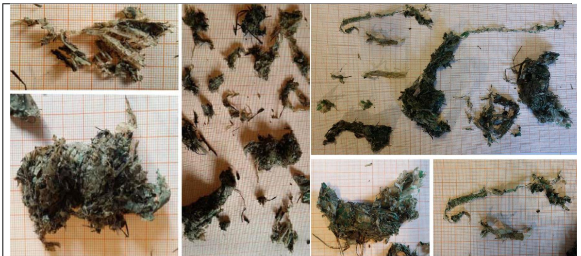
Bild 4-9: Beispiel für nicht vollständig anaerob abgebaute BAW-Beutel [Daal 2016]
