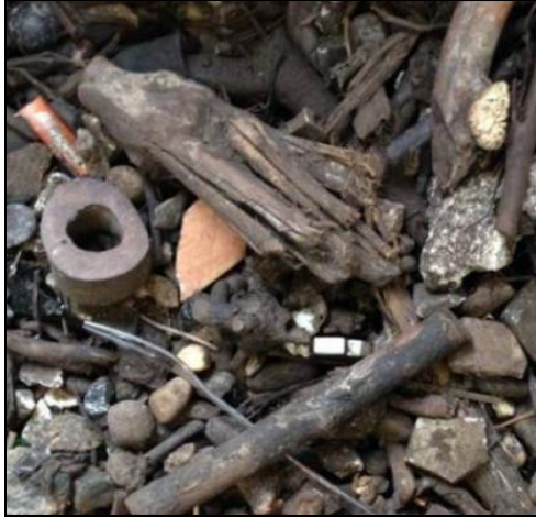
Bild 6-8: Schwergut (links) und Kunststofffraktion (rechts) aus der Kompostaufbereitung mittels Sichter und NIR [RTT-Steinert 2016]
